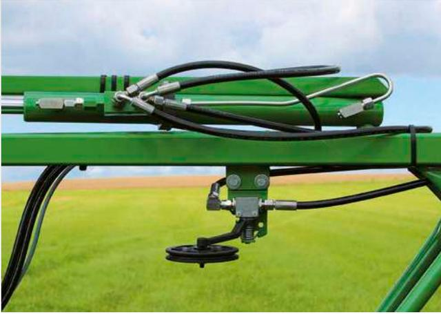
✔ Die Hydraulikverschraubungen in Edelstahl sichern lange Lebensdauer und hohen Wiederverkaufswert.
