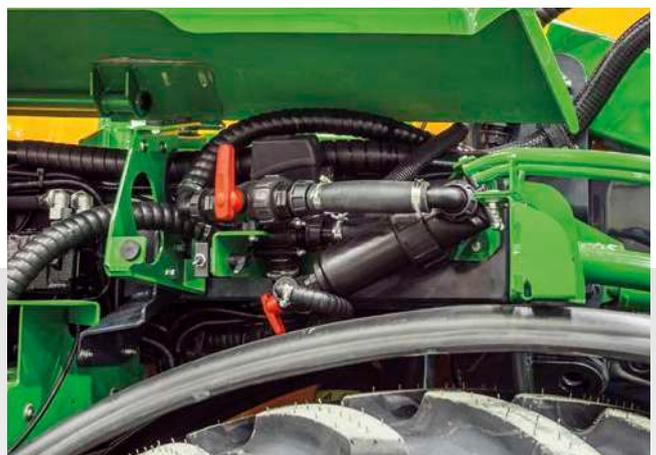
✔ Befüllanschluss im Ablagefach mit automatischem Befüllstopp
