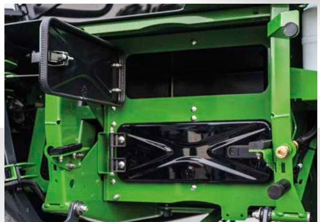
✔ Die staubdichte Transport-Box unter der Kabine
