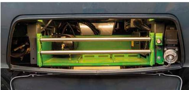
✔ Praktisch und groß – das Ablagefach für den Saugschlauch
